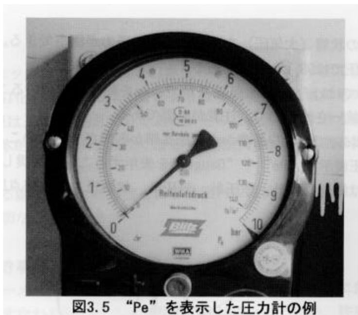
図3.5 “Pe” を表示した圧力計の例
