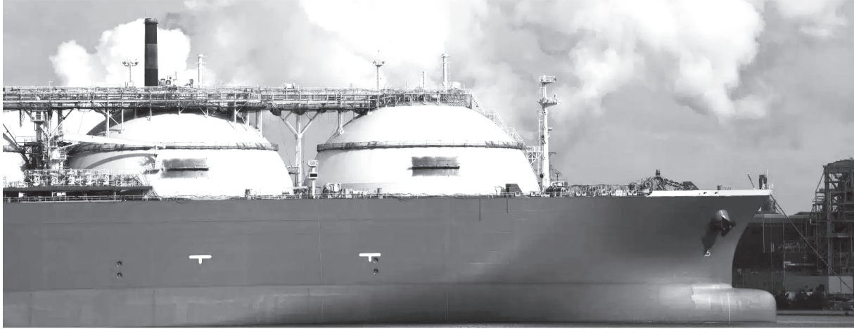
写真はLNG(液化天然ガス)タンカー。天然ガスを極低温で液化し、体積を600分の1に圧縮して大量輸送する専用船。
