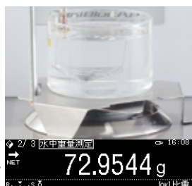
画面の指示に従い水中皿に載せます
