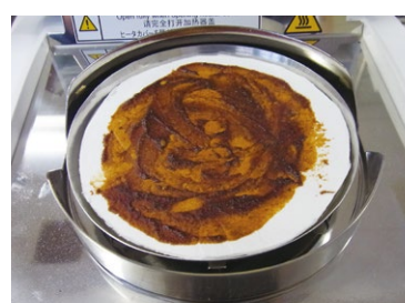
MOC63uに田楽みそを塗ったガラスファイバーシートを載せた状態
