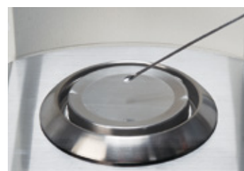
計量スプーンが帯電し 近づけただけで数値が動く場合
