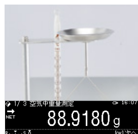
まず空中重量を測定します
